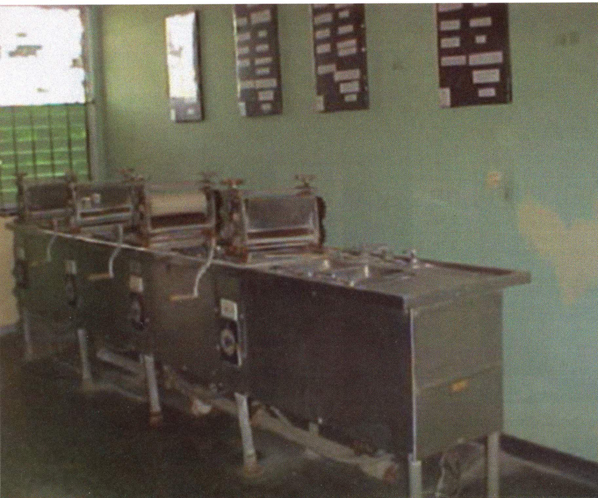
Leviatán, equipo utilizado para lavar la fibra de alpacas.
