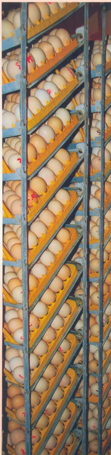
Las incubadoras de carga-múltiple, estanterías fijas con pasillo central de acceso, poseen un patrón vertical de flujo de aire y un patrón de carga horizontal.
