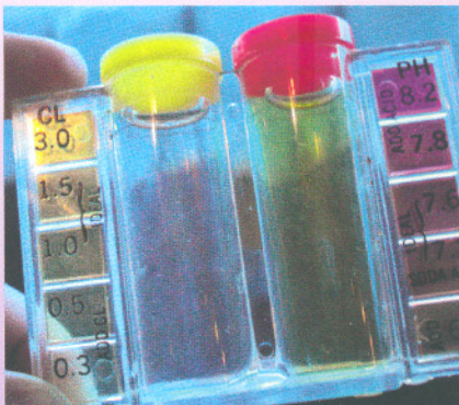
Medidor de cloro marca nivel cero
